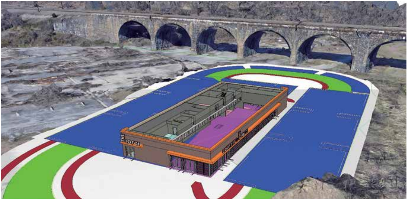
기존 조건에 대한 설계 상황을 제공하기 위해 포인트 클라우드와 현실 모델이 설계 모델에 참조될 수 있다.
