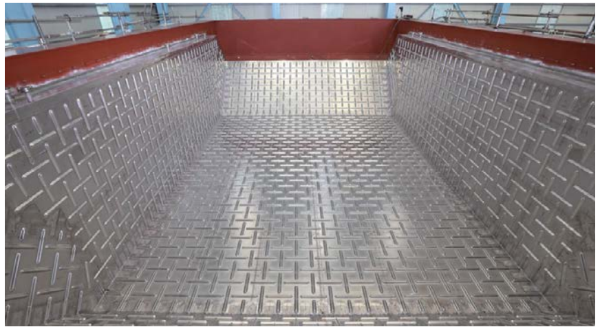
대우조선해양이 개발한 LNG 화물창 '솔리더스'의 실물 모형
