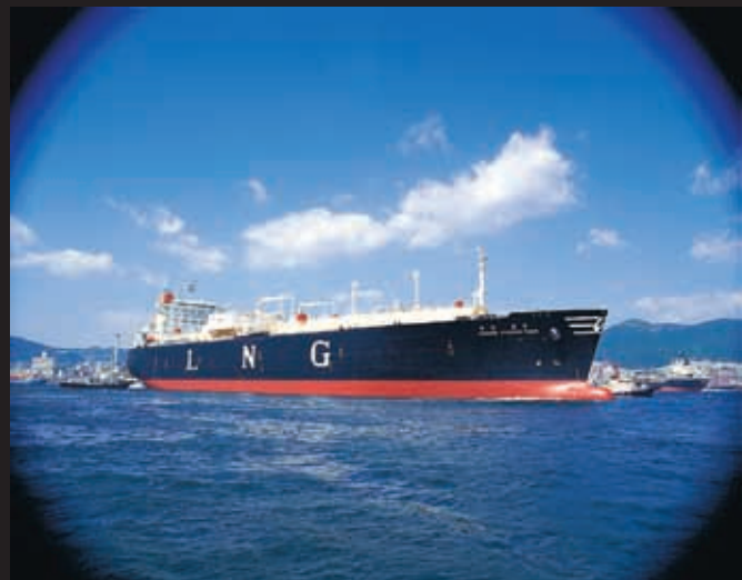
Hanjin Pyeongtaek 130,697m 3 LNG carrier 268.00 X 43.00 X 27.00 X 11.00 (L X B X D X D, m)
