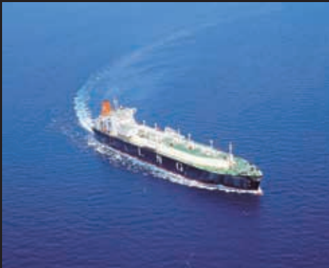
Hanjin Muscat 138,000m 3 LNG carrier 280.00 X 43.00 X 26.20 X 11.30 (L X B X D X D, m)
