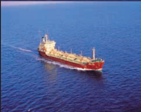
Ulsan Gas 4,000m 3 LNG carrier 108.00 X 16.10 X 8.00 X 5.00 (L X B X D X D, m)
