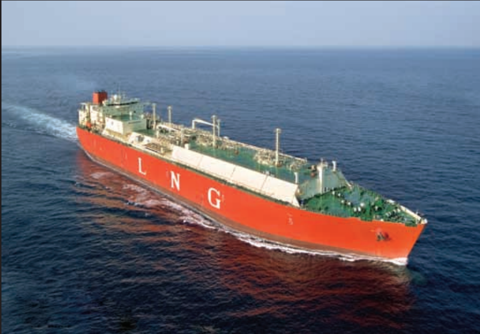
Hanjin Muscat 138,000m 3 LNG carrier 280.00 X 43.00 X 26.20 X 11.30 (L X B X D X D, m)
